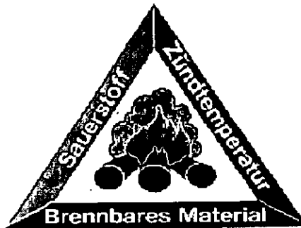
Abbildung 11: Verbrennungsdreieck ( die Stoffe bilden ein gleichseitiges Dreieck)
